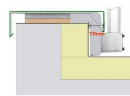
Die Abdeckung wird abhängig von der Oberflächenbehandlung der Attika innen und außen (Isolierung, Abdichtung, Anstrich...) nach Maß hergestellt.
